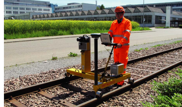
Altyapı ölçümü için GNSS opsiyonu ile Amberg IMS 5000
