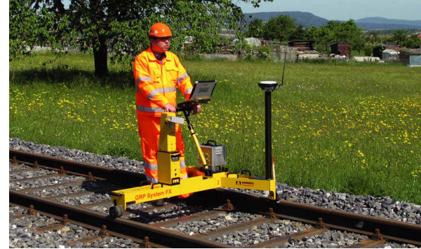
Son-durum ray hattı ölçümü için GNSS opsiyonu ile Amberg IMS 3000
