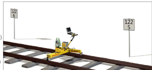
Amberg IMS 1000 ile rölatif ray hattı geometrisi ölçümü
