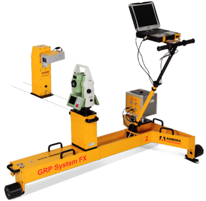
Ön: Total station ile birlikte Amberg IMS 1000 Arka: Amberg IMS 3000 için Profiler 110 FX
