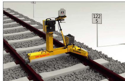
Rölatif ray hattı geometrisi ve altyapı ölçümü
